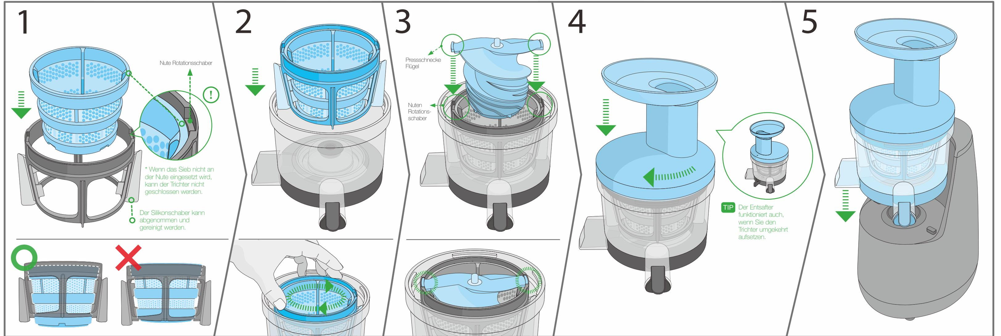
Setzen Sie das Sieb, genau wie im Bild, an der Nute des Rotationsschabers ein.
